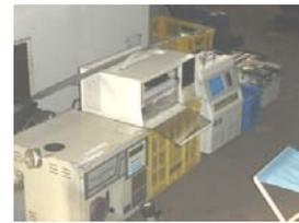
▲窒素酸化物・酸素濃度計測装置
