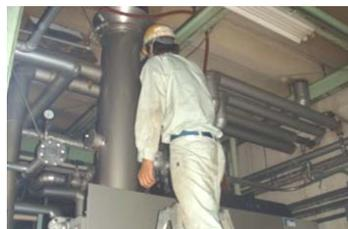
▲ばい煙測定のため、排気口にセンサーを取付
